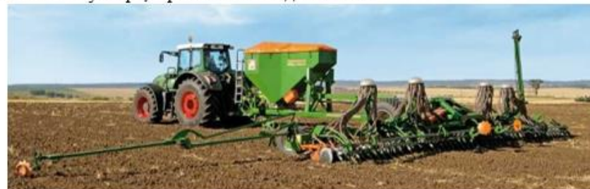
Рисунок 3 Высокопроизводительная сеялка Citan – по предварительно обработанной почве, ширина захвата от 6 до 15м.
