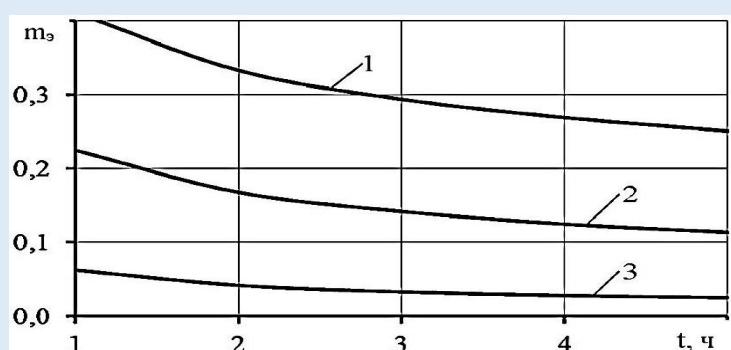
Рисунок 2. - Изменение относительного количества эксплуатационных отказов систем питания (1), смазки (2) и охлаждения (3)
