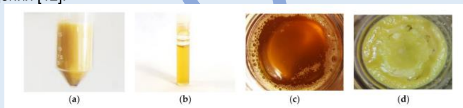
Рисунок 3 - Жир личинок H.illucens : (а) нативный; (b) после центрифугирования; (с) жидкий ( t = 40 \text{ }^\circ\text{C} );(d) твердый ( t = 20 \text{ }^\circ\text{C} ) [12].
